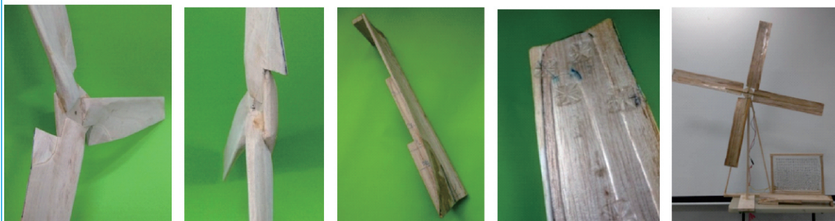
圖5：用切削的方法製作木製風車。轂部區段用雙層木板加厚後再加工，使得木製風車更滿足完美的設計要求(左側兩幀照片)；用複材技術製作巴沙木複材風車(右側三張照片)。
